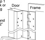
ALL HOLE LOCATIONS ON HINGE LEAF MUST BE FASTENED TO FRAME FOR PROPER OPERATION. FAILURE TO INSTALL ALL FASTENERS WILL VOID WARRANTY AND UL FIRE LABEL LISTINGS.
